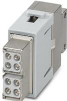
Kontakteinsatzmodul, Polzahl: 8, Buchse, Crimpanschluss, 48 V, 10 A, 0,14 mm<sup>2</sup> ... 1,5 mm<sup>2</sup>, Leitungsaußendurchmesser: 4,5 mm ... 9 mm, Anwendung: Daten/Signal, ohne Crimpkontakte
