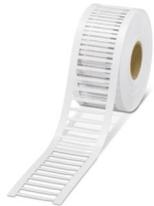
Kabelmarker, Rolle, weiß, unbeschriftet, beschriftbar mit: THERMOMARK E.300 (D)/600 (D), THERMOMARK ROLL 2.0, THERMOMARK ROLL, THERMOMARK ROLL X1, THERMOMARK ROLLMASTER 300/600, Kabeldurchmesserbereich: 0,6 ... 45 mm, Montageart: einschieben, Anzahl der Einzelschilder: 3000, Textfeldhöhe: 4 mm, Textfeldbreite: 18 mm
