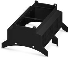
Tragschienengehäuse für den Einsatz in Installationsverteilern nach DIN 43880, Gehäuseoberteil (U11) mit Lüftungsschlitzen, Einbautiefe Anschluss technik: 11,1 mm, Breite: 107,6 mm, Höhe: 89,7 mm, Tiefe: 54,85 mm, Farbe: schwarzgrau (ähnlich RAL 7021)
