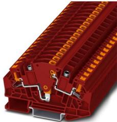
Messwandler-Trennklemme, Nennspannung: 1000 V, Nennstrom: 30 A, Anschlussart: Push-in-Anschluss, Bemessungsquerschnitt: 6 mm<sup>2</sup>, Querschnitt: 0,5 mm<sup>2</sup> - 6 mm<sup>2</sup>, Farbe: rot
