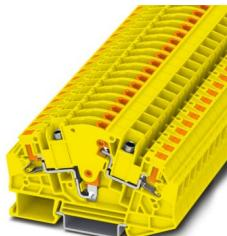
Messwandler-Trennklemme, Nennspannung: 1000 V, Nennstrom: 30 A, Anschlussart: Push-in-Anschluss, Bemessungsquerschnitt: 6 mm<sup>2</sup>, Querschnitt: 0,5 mm<sup>2</sup> - 6 mm<sup>2</sup>, Farbe: gelb
