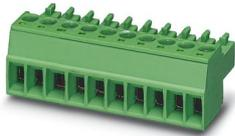
Leiterplattenstecker, Nennquerschnitt: 1,5 mm<sup>2</sup>, Farbe: grün, Nennstrom: 8 A, Bemessungsspannung (III/2): 160 V, Kontaktoberfläche: Sn, Kontaktart: Buchse, Anzahl der Reihen: 1, Polzahl: 5, Artikelfamilie: MC 1,5/..-ST, Rastermaß: 3,81 mm, Anschlussart: Schraubanschluss mit Zughülse, Schraubenangriffsform: L Längsschlitz, Anschlussrichtung Leiter/Platine: 0 °, Stecksystem: COMBICON MC 1,5, Verriegelung: ohne, Befestigungsart: ohne, Verpackungsart: verpackt im Karton
