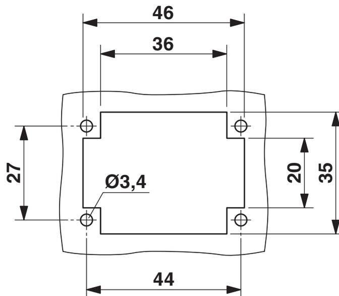
Montageausschnitt bei Verwendung ohne Gehäuse
