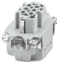
Kontakteinsatz, Polzahl: 6+2 PE, Baugröße: B6, Anzahl der Anschlüsse je Pol: 1, Buchse, Push-in-Anschluss, 500 V, 16 A, 0,14 mm<sup>2</sup> ... 2,5 mm<sup>2</sup>, Anwendung: Leistung, werkzeuglose Click-in-Montage
