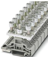
Hochstromverbinder, Nennspannung: 1000 V, Nennstrom: 125 A, Anzahl der Anschlüsse: 2, Anschlussart: Bolzenanschluss, Bemessungsquerschnitt: 35 mm<sup>2</sup>, Montageart: NS 35/7,5, NS 35/15, Farbe: grau
