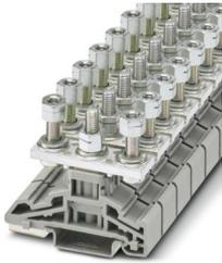
Hochstromverbinder, Nennspannung: 1000 V, Nennstrom: 125 A, Anzahl der Anschlüsse: 2, Anschlussart: Bolzenanschluss, Bemessungsquerschnitt: 35 mm<sup>2</sup>, 1. Etage, Montageart: NS 35/7,5, NS 35/15, Farbe: grau
