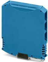
Tragschienengehäuse, Komplettgehäuse mit Metallfußriegel, hohe Bauform, mit Lüftungsschlitzen, Breite: 17,6 mm, Höhe: 99 mm, Tiefe: 113,65 mm, Farbe: blau (ähnlich RAL 5015), Querverbindung: Tragschienen-Busverbinder (optional), Polzahl Querverbinder: 5
