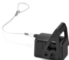
Schutzdeckel M1, mit Längsbügel, Material Schutzdeckel: PC, Höhe: 40,1 mm, Dichtung: ja, für Tüllengehäuse
