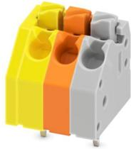
Leiterplattenklemme, Nennstrom: 8 A, Bemessungsspannung (III/2): 400 V, Nennquerschnitt: 1,5 mm<sup>2</sup>, Anzahl der Reihen: 1, Polzahl pro Reihe: 3, Artikelfamilie: PTSA 1,5, Rastermaß: 3,5 mm, Anschlussart: Push-in-Federanschluss, Montage: Wellenlöten, Anschlussrichtung Leiter/Platine: 45 °, Farbe: mehrfarbig, Pin-Layout: Zick-Zack-Pinning M, Pinlänge [P]: 3,5 mm, Anzahl der Lötpins pro Potenzial: 1, Verpackungsart: verpackt im Karton
