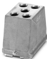
Tüllengehäuse B48, für Längsbügel, Material: Aluminiumdruckguss, seewasserbeständig, Kabelabgänge: 5, gerade, M25, Höhe: 107,5 mm, Kabelverschraubung: ohne, Standard
