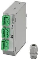
Spleißbox, Bauform: Tragschienenmodul, Schutzart: IP20, Material: Metall, Anschlussart: Spleißen, Kabelabgang: oben und unten, Gehäusegröße: 1, Farbe: grau
