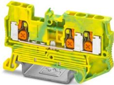
Schutzleiterklemme, Anzahl der Anschlüsse: 3, Polzahl: 1, Anschlussart: Push-X-Anschluss, Bemessungsquerschnitt: 2,5 mm<sup>2</sup>, Querschnitt: 0,5 mm<sup>2</sup> - 4 mm<sup>2</sup>, Montageart: NS 35/7,5, NS 35/15, Farbe: grün-gelb
