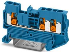
Durchgangsklemme, Nennspannung: 800 V, Nennstrom: 24 A, Anzahl der Anschlüsse: 3, Polzahl: 1, Anschlussart: Push-X-Anschluss, Bemessungsquerschnitt: 2,5 mm<sup>2</sup>, Querschnitt: 0,5 mm<sup>2</sup> - 4 mm<sup>2</sup>, Montageart: NS 35/7,5, NS 35/15, Farbe: blau
