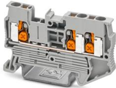
Durchgangsklemme, Nennspannung: 800 V, Nennstrom: 24 A, Anzahl der Anschlüsse: 3, Polzahl: 1, Anschlussart: Push-X-Anschluss, Bemessungsquerschnitt: 2,5 mm<sup>2</sup>, Querschnitt: 0,5 mm<sup>2</sup> - 4 mm<sup>2</sup>, Montageart: NS 35/7,5, NS 35/15, Farbe: grau
