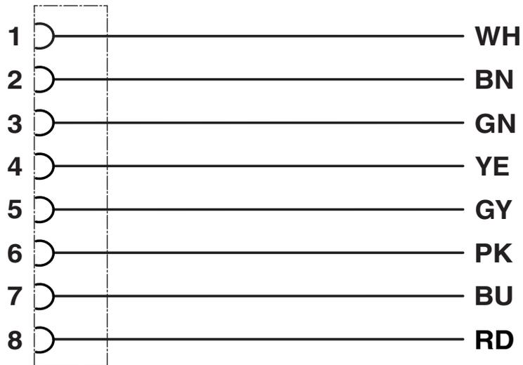
Kontaktbelegung der M12-Buchse
