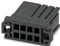
Leiterplattenstecker, Farbe: schwarz, Nennstrom: 8 A, Bemessungsspannung (III/2): 160 V, Kontaktoberfläche: Sn, Kontaktart: Buchse, Anzahl der Reihen: 2, Polzahl: 8, Artikelfamilie: DD31PC 2,2/..., Rastermaß: 3,81 mm, Anschlussart: Crimpanschluss, Anschlussrichtung Leiter/Platine: 0 °, Rasthaken: - ohne Rasthaken, Stecksystem: CONNEXIS DD, Verriegelung: Rastverriegelung, Befestigungsart: Rastflansch, Verpackungsart: verpackt im Karton
