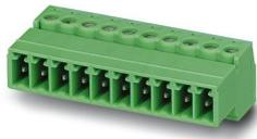
Leiterplattenstecker, Nennquerschnitt: 1,5 mm<sup>2</sup>, Farbe: grün, Nennstrom: 8 A, Bemessungsspannung (III/2): 160 V, Kontaktoberfläche: Sn, Kontaktart: Stift, Anzahl der Reihen: 1, Polzahl: 3, Artikelfamilie: IMC 1,5/...-ST, Rastermaß: 3,81 mm, Anschlussart: Schraubanschluss mit Zughülse, Schraubenangriffsform: L Längsschlitz, Anschlussrichtung Leiter/Platine: 0 °, Stecksystem: COMBICON MC 1,5, Verriegelung: ohne, Befestigungsart: ohne, Verpackungsart: verpackt im Karton
