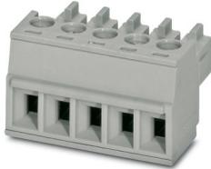
Leiterplattenstecker, Nennquerschnitt: 1,5 mm<sup>2</sup>, Farbe: weißgrün, Nennstrom: 8 A, Bemessungsspannung (III/2): 160 V, Kontaktoberfläche: Sn, Kontaktart: Buchse, Anzahl der Reihen: 1, Polzahl: 5, Artikelfamilie: BCP, Rastermaß: 3,81 mm, Anschlussart: Schraubanschluss mit Zughülse, Schraubenangriffsform: L Längsschlitz, Anschlussrichtung Leiter/Platine: 0 °, Stecksystem: BASICLINE 1,5, Verriegelung: ohne, Befestigungsart: ohne, Verpackungsart: verpackt im Karton
