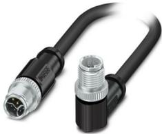
Hybridkabel, Ethernet Hybrid CAT5 (100 MBit/s), 8-polig, PUR halogenfrei, schwarz RAL 9005, geschirmt (Advanced Shielding Technology), Stecker gerade M12, Kodierung: Y / IP65/IP67, auf Stecker gewinkelt M12, Kodierung: Y / IP65/IP67, Kabellänge: 10 m, Power with Ethernet (PWE)
