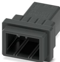
Leiterplattenstecker, Farbe: schwarz, Nennstrom: 8 A, Bemessungsspannung (III/2): 160 V, Kontaktobерfläche: Sn, Kontaktart: Stift, Anzahl der Reihen: 2, Polzahl: 6, Artikelfamilie: DD31H 2,2/..-FH, Rastermaß: 3,81 mm, Anschlussart: Crimpanschluss, Anschlussrichtung Leiter/Platine: 0 °, Pin-Layout: Lineares Pinning, Rasthaken: - ohne Rasthaken, Stecksystem: CONNEXIS DD, Verriegelung: Rastverriegelung, Befestigungsart: Rastnase, Verpackungsart: verpackt im Karton
