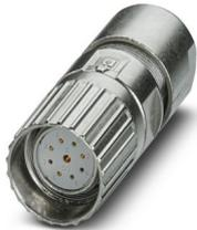
M23, Kabelsteckverbinder, Serie: M23 PRO, gerade, geschirmt: ja, Schraubverriegelung, Polzahl: 8+1, Drehsinn: Standard, Kontaktart: Buchse, Lötanschluss, Kabeldurchmesserbereich: 6 mm ... 10 mm, Kodierung: N, Artikel ist bleifrei nach RoHS II ohne Ausnahme 6c (Pb < 0,1 %)
