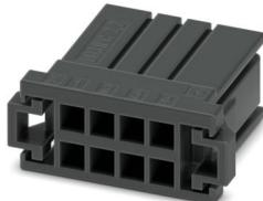
Leiterplattenstecker, Farbe: schwarz, Nennstrom: 8 A, Bemessungsspannung (III/2): 160 V, Kontaktobерfläche: Sn, Kontaktart: Buchse, Anzahl der Reihen: 2, Polzahl: 8, Artikelfamilie: DD31PC 2,2/.., Rastermaß: 3,81 mm, Anschlussart: Crimpanschluss, Anschlussrichtung Leiter/Platine: 0 °, Rasthaken: - ohne Rasthaken, Stecksystem: CONNEXIS DD, Verriegelung: Rastverriegelung, Befestigungsart: Rastflansch, Verpackungsart: verpackt im Karton
