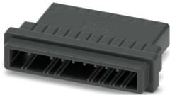
Leiterplattenstecker, Farbe: schwarz, Nennstrom: 8 A, Bemessungsspannung (III/2): 160 V, Kontaktoberfläche: Sn, Kontaktart: Stift, Anzahl der Reihen: 1, Polzahl: 10, Artikelfamilie: D31H 2,2/..-FH, Rastermaß: 3,81 mm, Anschlussart: Crimpanschluss, Anschlussrichtung Leiter/Platine: 0 °, Rasthaken: - ohne Rasthaken, Stecksystem: CONNEXIS D, Verriegelung: Rastverriegelung, Befestigungsart: Rastnase, Verpackungsart: verpackt im Karton
