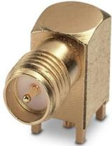
Koaxial-Leiterplatten-Steckverbinder, Schutzart: IP20, Polzahl: 1, 12 GBit/s, Material: Metall, Anschlussart: Lötanschluss, Kabelabgang: gerade
