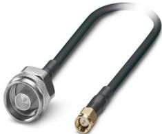
Koaxialkabel 50  $\Omega$ , Länge: 5 m, N(m) - SMA(m), Leitungsaußendurchmesser: 4,9 mm, Übertragungsfrequenz:  $\leq$  7,25 GHz, Typische Dämpfung: 800 MHz 2,3 dB, 2,4 GHz 3,8 dB, 5,8 GHz 6 dB, 7,25 GHz 7,3 dB
