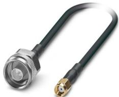
Koaxialkabel 50  $\Omega$ , Länge: 5 m, N(m) - RSMA(m), Leitungsaußendurchmesser: 4,9 mm, Übertragungsfrequenz:  $\leq$  7,25 GHz, Typische Dämpfung: 800 MHz 2,3 dB, 2,4 GHz 3,8 dB, 5,8 GHz 6 dB, 7,25 GHz 7,3 dB
