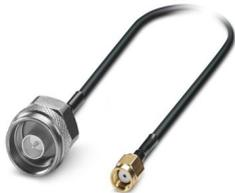
Koaxialkabel 50  $\Omega$ , Länge: 0,5 m, N(m) - RSMA(m), Leitungsaußendurchmesser: 2,8 mm, Übertragungsfrequenz:  $\leq$  7,25 GHz, Typische Dämpfung: 800 MHz 0,4 dB, 2,4 GHz 0,7 dB, 5,8 GHz 1,1 dB, 7,25 GHz 1,5 dB
