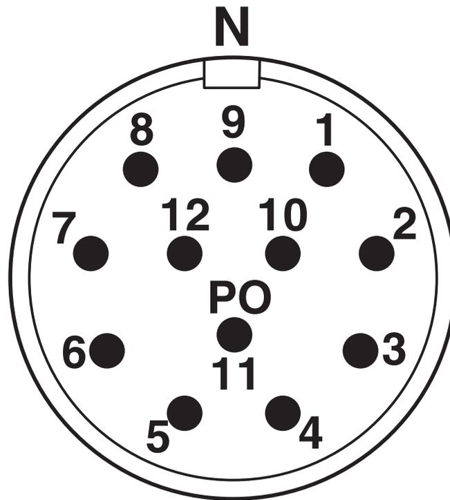
Kontaktkammernummerierung (Ansicht Steckseite) Stift Standard
