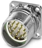
M23, Gerätesteckverbinder Vorderwand, Serie: M23 PRO Signal, gerade, geschirmt: ja, für Standard- und ONECLICK-Schnellverriegelung, Polzahl: 12, Drehsinn: Standard, Kontaktart: Stift, Lötanschluss, Flanschmaß: 26 mm x 26 mm, Kodierung: N, Artikel ist bleifrei nach RoHS II ohne Ausnahme 6c (Pb < 0,1 %)
