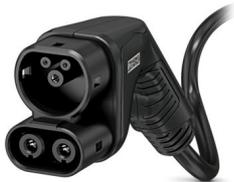
CHARX connect compact, CCS Typ 2, DC-Ladeleitung, 80 A dauerhaft, 1000 V DC, mit Fahrzeug-Ladestecker und offenem Leitungsende, Kabel: 7,5 m, schwarz, gerade, mit angeschlossenem PP-Kontakt, mit analoger Temperatursensorik, PHOENIX CONTACT-Logo, ACHTUNG: Kabelmanagement ggf. erforderlich., IEC 62196-3, zum Laden mit Gleichstrom (DC) von Elektrofahrzeugen (EV)
