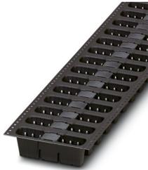
Stiftleiste, Nennquerschnitt: 1,5 mm<sup>2</sup>, Farbe: schwarz, Nennstrom: 12 A (Abhängig von verwendetem Stecker), Bemessungsspannung (III/2): 320 V, Kontaktoberfläche: Sn, Kontaktart: Stift, Anzahl der Reihen: 1, Polzahl: 4, Artikelfamilie: PST 1,3/..-V, Rastermaß: 5 mm, Montage: THR-Löten / Wellenlöten, Pin-Layout: Lineares Pinning, Pinlänge [P]: 3,5 mm, Stecksystem: COMBICON PST 1,3, Verriegelung: ohne, Befestigungsart: ohne, Verpackungsart: Gurt in 56 mm Breite
