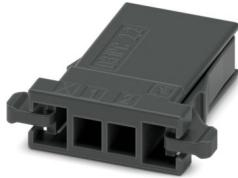
Leiterplattenstecker, Farbe: schwarz, Nennstrom: 8 A, Bemessungsspannung (III/2): 160 V, Kontaktobерfläche: Sn, Kontaktart: Buchse, Anzahl der Reihen: 1, Polzahl: 2, Artikelfamilie: D31PC 2,2/.., Rastermaß: 3,81 mm, Anschlussart: Crimpanschluss, Anschlussrichtung Leiter/Platine: 0 °, Rasthaken: - ohne Rasthaken, Stecksystem: CONNEXIS D, Verriegelung: Rastverriegelung, Befestigungsart: Rastflansch, Verpackungsart: verpackt im Karton
