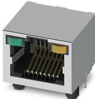
RJ45-Leiterplatten-Steckverbinder, Polzahl: 8, 10 GBit/s, Leiterplattenmontage, Schutzart: IP20, Anschlussart: THR-Reflow / THT-Welle, Tape and Reel
