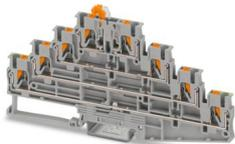
Messertrennklemme, Schutzleiteranschluss, Anschlussart: Push-in-Anschluss, Bemessungsquerschnitt: 2,5 mm<sup>2</sup>, Querschnitt: 0,14 mm<sup>2</sup> - 4 mm<sup>2</sup>, Durchgangsetage, Anschlussart: Push-in-Anschluss, Bemessungsquerschnitt: 2,5 mm<sup>2</sup>, Querschnitt: 0,14 mm<sup>2</sup> - 4 mm<sup>2</sup>, Montage: NS 35/7,5, NS 35/15, Farbe: grau
