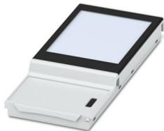
Tragschienegehäuse für den Einsatz in Installationsverteilern nach DIN 43880, Rastdeckel (unlösbar), kapazitives 2,4"-Touchdisplay integriert, Auflösung: 320 x 240 Pixel, Schnittstelle: 4-wire SPI, Breite: 107,6 mm, Höhe: 45 mm, Tiefe: 13,5 mm
