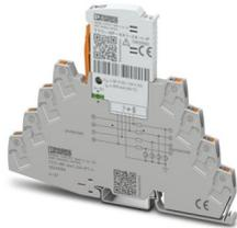
Überspannungsschutz, bestehend aus Schutzstecker und Basiselement, mit integrierter Statusanzeige für vier Signaladern mit gemeinsamem Bezugspotenzial, z. B. Digital IN/OUT.
