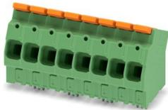
Leiterplattenklemme, Nennstrom: 76 A, Bemessungsspannung (III/2): 1000 V, Nennquerschnitt: 16 mm<sup>2</sup>, Anzahl der Potenziale: 8, Anzahl der Reihen: 1, Polzahl pro Reihe: 8, Artikelfamilie: LPTA 16/, Rastermaß: 10 mm, Anschlussart: Hebel-Push-in-Anschluss, Montage: Wellenlöten, Anschlussrichtung Leiter/Platine: 30 °, Farbe: grün, Pin-Layout: Zick-Zack-Pinning W, Pinlänge [P]: 3,6 mm, Verpackungsart: verpackt im Karton
