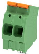
Leiterplattenklemme, Nennstrom: 76 A, Bemessungsspannung (III/2): 1000 V, Nennquerschnitt: 16 mm<sup>2</sup>, Anzahl der Potenziale: 2, Anzahl der Reihen: 1, Polzahl pro Reihe: 2, Artikelfamilie: LPTA 16/, Rastermaß: 10 mm, Anschlussart: Hebel-Push-in-Anschluss, Montage: Wellenlöten, Anschlussrichtung Leiter/Platine: 30 °, Farbe: grün, Pin-Layout: Zick-Zack-Pinning W, Pinlänge [P]: 3,6 mm, Verpackungsart: verpackt im Karton
