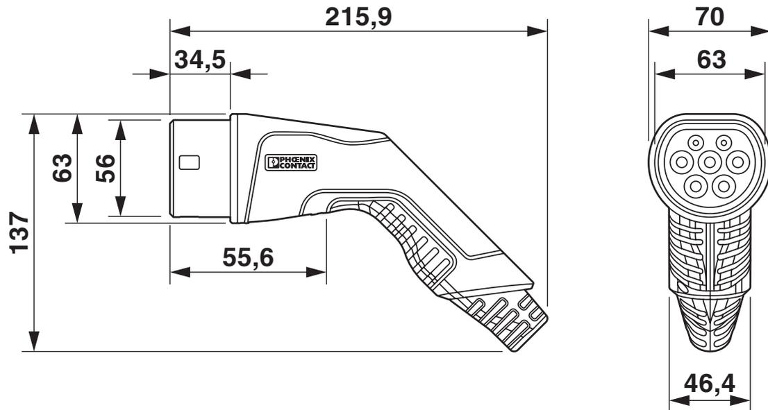
Stellen Sie sicher, dass der Fahrzeug-Ladestecker während der gesamten Ladepausenzeit in eine geeignete Ladesteckerhalterung gesteckt wird, die einen Schutz von mindestens IP24 nach IEC 61851-1 gewährleistet. Zur Erstellung einer solchen Ladesteckerhalterung verwenden Sie die Maße des Fahrzeug-Ladesteckers. Detailliertere Maßangaben finden Sie auch im Download-Bereich.
