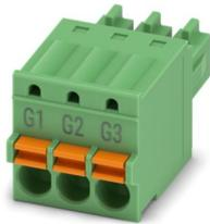
Leiterplattenstecker, Nennquerschnitt: 1,5 mm<sup>2</sup>, Farbe: grün, Nennstrom: 8 A, Bemessungsspannung (III/2): 160 V, Kontaktoberfläche: Sn, Kontaktart: Buchse, Anzahl der Reihen: 1, Polzahl: 3, Artikelfamilie: FK-MCP 1,5/..-ST, Rastermaß: 3,5 mm, Anschlussart: Push-in-Federanschluss, Anschlussrichtung Leiter/Platine: 0 °, Stecksystem: COMBICON MC 1,5, Verriegelung: ohne, Befestigungsart: ohne, Verpackungsart: verpackt im Karton
