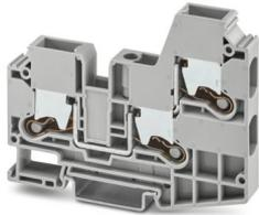
Durchgangsklemme, Nennspannung: 1000 V, Nennstrom: 57 A, Anzahl der Anschlüsse: 3, Polzahl: 1, Anschlussart: Push-X-Anschluss, Bemessungsquerschnitt: 10 mm<sup>2</sup>, Querschnitt: 1,5 mm<sup>2</sup> - 16 mm<sup>2</sup>, Montageart: NS 35/7,5, NS 35/15, Farbe: grau
