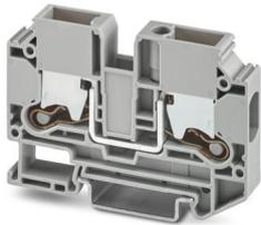
Durchgangsklemme, Nennspannung: 1000 V, Nennstrom: 57 A, Anzahl der Anschlüsse: 2, Polzahl: 1, Anschlussart: Push-X-Anschluss, Bemessungsquerschnitt: 10 mm<sup>2</sup>, Querschnitt: 1,5 mm<sup>2</sup> - 16 mm<sup>2</sup>, Montageart: NS 35/7,5, NS 35/15, Farbe: grau
