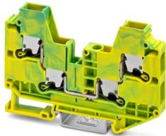
Schutzleiterklemme, Anzahl der Anschlüsse: 4, Polzahl: 1, Anschlussart: Push-X-Anschluss, Bemessungsquerschnitt: 6 mm<sup>2</sup>, Querschnitt: 0,5 mm<sup>2</sup> - 10 mm<sup>2</sup>, Montageart: NS 35/7,5, NS 35/15, Farbe: grün-gelb
