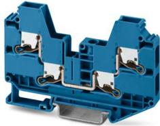
Durchgangsklemme, Nennspannung: 1000 V, Nennstrom: 41 A, Anzahl der Anschlüsse: 4, Polzahl: 1, Anschlussart: Push-X-Anschluss, Bemessungsquerschnitt: 6 mm<sup>2</sup>, Querschnitt: 0,5 mm<sup>2</sup> - 10 mm<sup>2</sup>, Montageart: NS 35/7,5, NS 35/15, Farbe: blau
