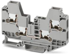
Durchgangsklemme, Nennspannung: 1000 V, Nennstrom: 41 A, Anzahl der Anschlüsse: 4, Polzahl: 1, Anschlussart: Push-X-Anschluss, Bemessungsquerschnitt: 6 mm<sup>2</sup>, Querschnitt: 0,5 mm<sup>2</sup> - 10 mm<sup>2</sup>, Montageart: NS 35/7,5, NS 35/15, Farbe: grau
