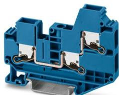
Durchgangsklemme, Nennspannung: 1000 V, Nennstrom: 41 A, Anzahl der Anschlüsse: 3, Polzahl: 1, Anschlussart: Push-X-Anschluss, Bemessungsquerschnitt: 6 mm<sup>2</sup>, Querschnitt: 0,5 mm<sup>2</sup> - 10 mm<sup>2</sup>, Montageart: NS 35/7,5, NS 35/15, Farbe: blau
