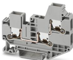
Durchgangsklemme, Nennspannung: 1000 V, Nennstrom: 41 A, Anzahl der Anschlüsse: 3, Polzahl: 1, Anschlussart: Push-X-Anschluss, Bemessungsquerschnitt: 6 mm<sup>2</sup>, Querschnitt: 0,5 mm<sup>2</sup> - 10 mm<sup>2</sup>, Montageart: NS 35/7,5, NS 35/15, Farbe: grau
