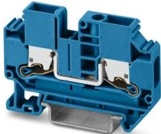
Durchgangsklemme, Nennspannung: 1000 V, Nennstrom: 41 A, Anzahl der Anschlüsse: 2, Polzahl: 1, Anschlussart: Push-X-Anschluss, Bemessungsquerschnitt: 6 mm<sup>2</sup>, Querschnitt: 0,5 mm<sup>2</sup> - 10 mm<sup>2</sup>, Montageart: NS 35/7,5, NS 35/15, Farbe: blau
